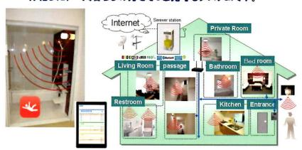
LEDライトに内蔵されたレーダーが要介蔵者との距離やバイタルデーターを計測し 転倒やしゃがみこみ等の容態の急変を捉え異常状態に応じて通報連絡します
